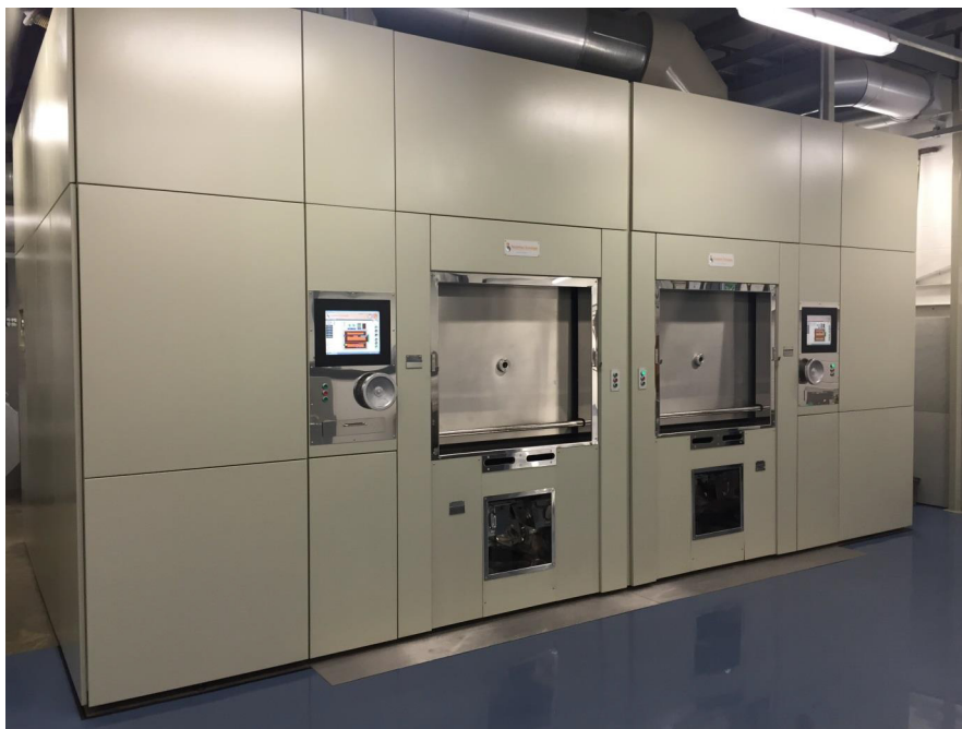
(avec 2 fours FT III capotés - y compris les refroidisseurs associés)
